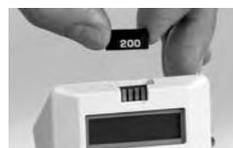
FIGURE 9-2 REMOVING THE ENCODER PLUG
