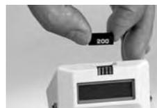
FIGURE 9-4 REPLACING THE ENCODER PLUG
